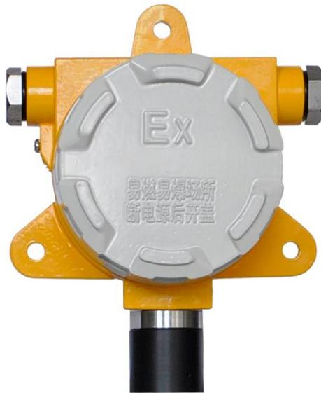
KB-501YW 烟雾报警器是我公司生产的新型烟雾检测报警器。本机是高灵敏度光学传感器和半导体传感器相结合的一款新型烟雾报警装置，通过半导体传感器（传感器主要检测烟雾中的易燃成分）和光学传感器同时进行烟雾探测。光学传感器主要通过接收烟尘粒子散射回来的两个波段（红外 870nm-900nm、红光 650nm-670nm）的光波然后特定的算法来进行检测。
